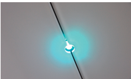
Kahden valkoisen lasilevyn välillä oleva diodi näyttää, mikä neljästä valittavissa olevasta nopeudesta on toiminnassa.
